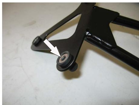
4. Die Elastikmuttern wie in Bild 5 in die Bohrungen am Kennzeichenträger stecken. Wenn Sie das Kennzeichen befestigen, legen Sie die Polyamid-U-Scheiben M5 zwischen Kennzeichen und Linsenflanschkopfschrauben!
