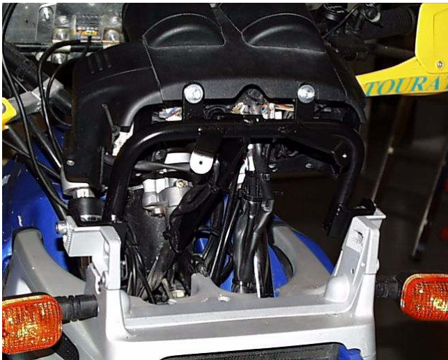
Montierter Vorbau mit Instrumenten
